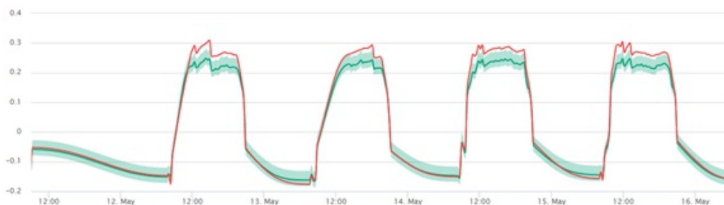
Abb. Die Verschiebung der Zentralachse eines Kompressors wird gemessen (rot) und modelliert (grün) anhand des Konfidenzintervalls des Modells (hellgrün). Es zeigt sich, dass das Modell das Verhalten der Maschine exakt modelliert, sogar während der Transienten, d.h. auch beim An- und Abfahren. Wir beobachten allerdings oft eine Abweichung zwischen dem Modell und den Messungen zu jenem Zeitpunkt, da Vollast erreicht wird. Das zeigt ein Maschinenproblem an, das einen Alarm auslöst.
